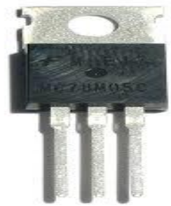
Fig.4.9 : 7805 voltage regulator IC
